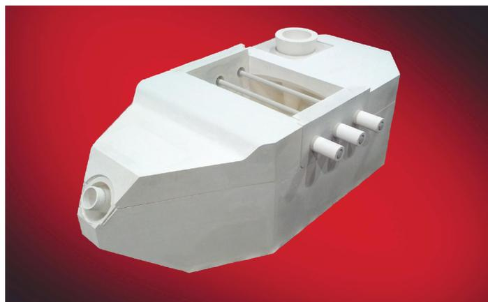
Система футеровки печи INSURAL полностью сухая. Как следствие, поглощение водорода из новой системы футеровки незначительно, и показатель требуемого индекса плотности расплава может быть достигнут в течение очень короткого периода после установки. Время простоя печи значительно сокращается, а риск увеличения брака уменьшается. Так как система футеровки не смачивается алюминием, то рост корунда минимален, а очистка печи упрощена.
